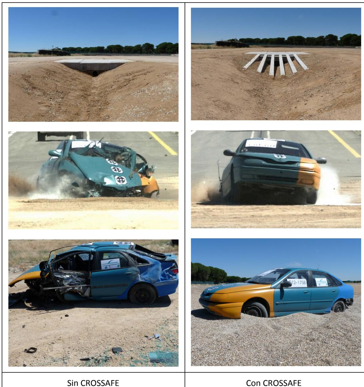
*Imagen 14.- Ensayos de impacto de turismo de 1.500 kg a 100 km/h y 0º sin y con sistema de protección de pasos salvacunetas Crossafe*
